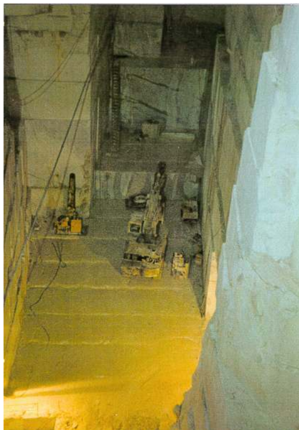
Fig. 7 – Sotterraneo con estrazione a pozzo: cava “Calocara A”, bacino di Miseglia.
